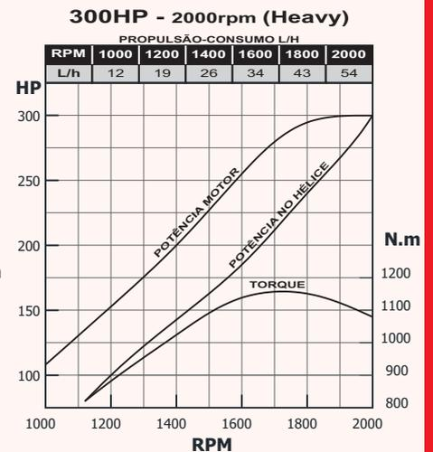
**IMPORTANTE:** Hélice dimensionado para alcançar RPM máxima do motor com embarcação carregada.
